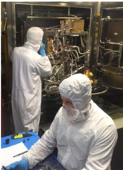
Fin 2017-début 2018, campagnes de vérifications et de calibrations du modèle FM de MOMA en chambre martienne à différentes températures opérationnelles (froid à -45°C et chaud -20°C) et différentes pression à la surface de Mars (4 Torr à 8 Torr)
