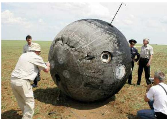
▶▶ Récupération des météorites artificielles enchâssées dans le bouclier thermique du satellite automatique russe Foton-M2. Retrieval of artificial meteorites embedded in the heatshield of a Russian Foton-M2 capsule.
